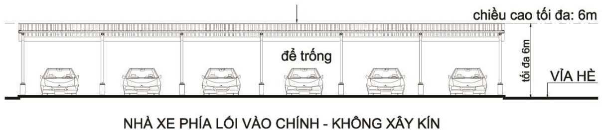
Hình 9-2: Mặt cắt công trình phụ
